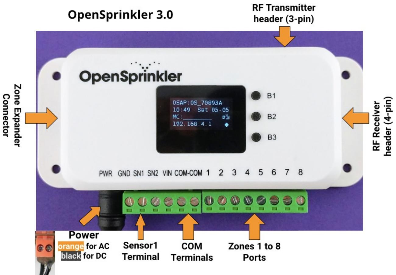
In der Regel verfügt jedes Magnetventil über zwei Drähte. Verbinden sie den einen Draht mit dem COM (Common) Anschluss, und den anderen Draht auf eine einzelnen Zonenöffnung (1 bis 8). Für mehrere Ventile wird ein Draht von jedem Ventil zusammen kombiniert und geht zur COM – Klemme; der andere Draht geht zu einer einzelnen Zonen Port. Wenn Sie nicht sicher sind, sollten Sie einen Landschaftsgartenbauer, einen Elektriker oder Hilfe in einem Baumarkt suchen.
